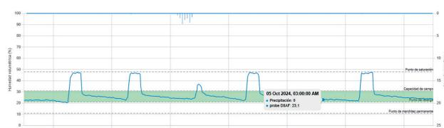
En primer lugar, se observan períodos de tiempo con el suelo en saturación: el VWC se mantiene estable en un nivel de 50%\*.
